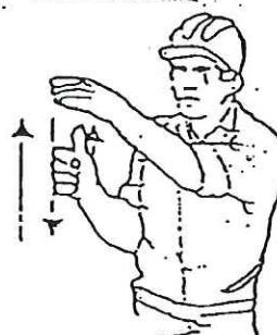
4 Levantar el aguilón o pluma lentamente.
