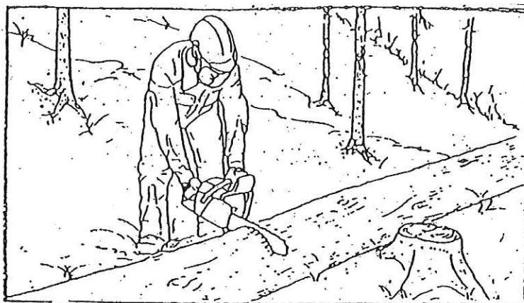
Fig 7 - En zonas de pendiente, situarse siempre por encima del árbol a cortar o trocear.
