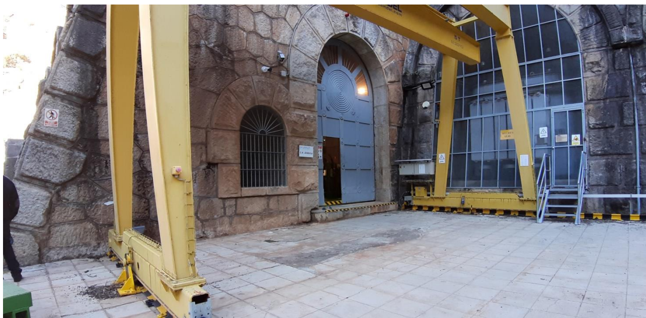
Central hidroeléctrica. Puente grúa para maniobrar elementos electromecánicos
